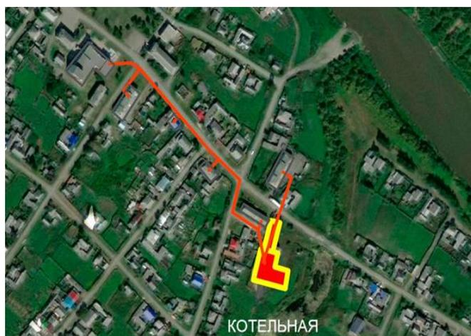
Рисунок 1.3.3 – Схема тепловых сетей котельной с. Краснослободское
